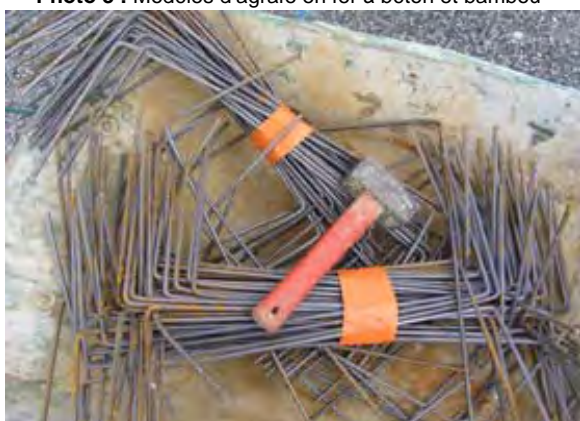
Photo 5 : Agrafe en U (20 x 50 x 2 cm) pour film/feutre : fer béton torsadé et épointé Ø 6 mm
