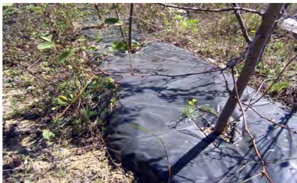
Photo 34 : Après 18 mois de présence sur site, le film plastique 80 µ en PE a une très bonne tenue générale, malgré quelques petits trous ponctuels sans conséquence sur l'efficacité herbicide du paillis
