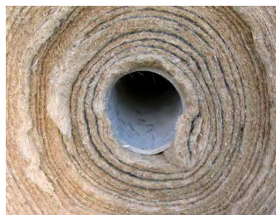
Photo 20 : Un mandrin en carton empêche la déformation du feutre Thorenep (SOTEXTHO)
