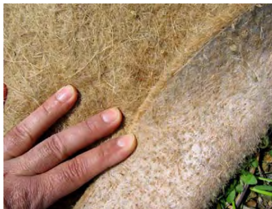
Photo 16 : Film non tissé blanc en polypropylène sur feutre dit « biodégradable »
