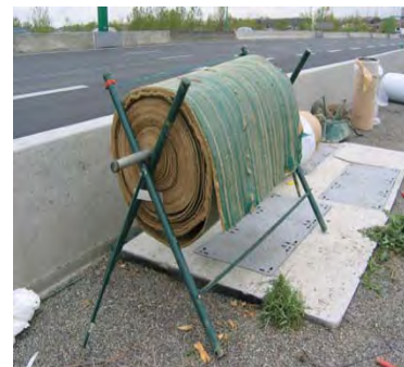
Photo 24 : Prototype de dérouleuse manuelle
