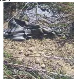
Photo 34 : Après 18 mois de présence sur site, le film plastique 80 µ en PE a une très bonne tenue générale, malgré quelques petits trous ponctuels sans conséquence sur l'efficacité herbicide du paillis
