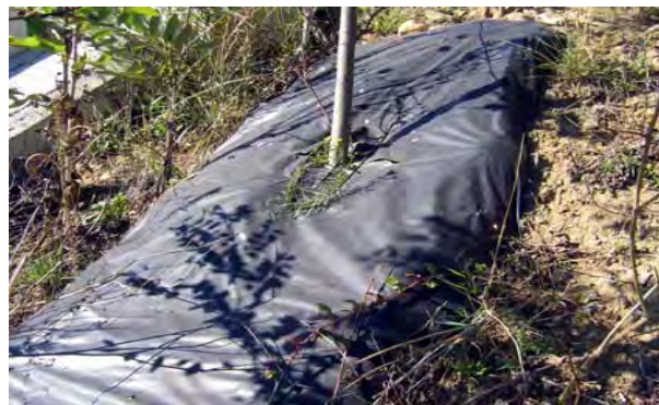
Photo 34 : Après 18 mois de présence sur site, le film plastique 80 µ en PE a une très bonne tenue générale, malgré quelques petits trous ponctuels sans conséquence sur l'efficacité herbicide du paillis
