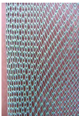
Photo 8 : Détail de la maille de la protection bioplastique
