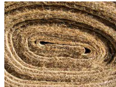
Photo 18 : Déformation d'un rouleau de feutre stocké en position horizontale
