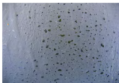
Photo 31 : En cas d'ensoleillement, le bioplastique commence à « transpirer »...
